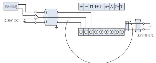
电池和 24V 双供电 + 压力传感器 + 温度传感器
