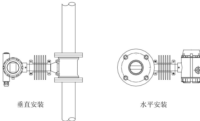
高介质温度时仪表的安装应使得电子部件在管道的一侧或管道的下方,在管道周围要求隔热使得温度保持在85℃以下
